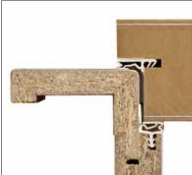
Zwei Dichtungsebenen durch die integrierte Türfalzdichtung und die akustisch wirksame Zargendichtung.
