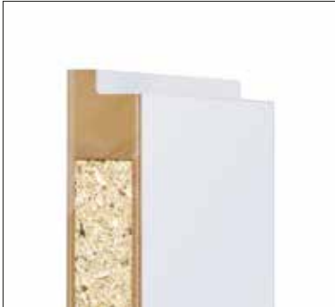
Schallschutzklasse 1 Türdicke ca. 40 mm Vollspaneinlage | SK1, RwP = 32 dB
